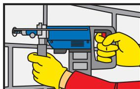
Realizar el agujero de diámetro y profundidad requeridos con un taladro eléctrico. El diámetro del taladro deberá ser acorde al diámetro de la barra a anclar.
